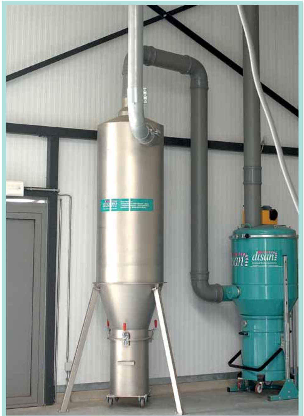
Een eenvoudige lediging van de afvallemmer met 100, 125 of 175 liter opvangcapaciteit.
